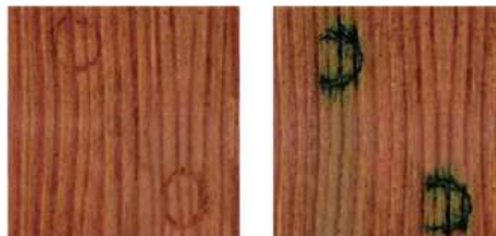
Hagelschlagbeschädigung nach einem Jahr Bewitterung: Links mit Pflegebalsam: intakte Oberfläche / Rechts ohne Pflegebalsam: Bläuebildung
