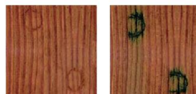
Hagelschlag nach einem Jahr Bewitterung. Links mit Pflegebalsam: intakte Oberfläche rechts ohne Pflegebalsam: Bläuebildung
